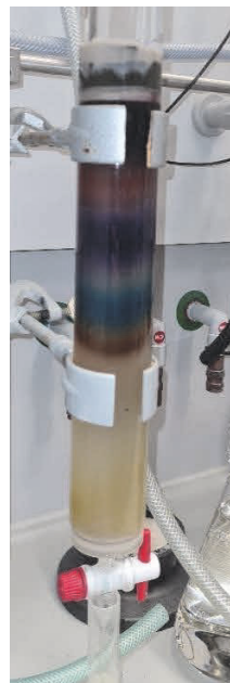
Abbildung 18: Foto der chromatographischen Reinigung des Rohprodukts nach der Aldol-Kondensation in Normalphase.
